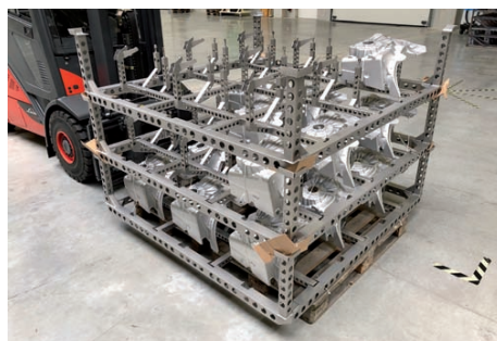
Das Warenträger-System besteht aus einer wiederverwendbaren Grundträgerkonstruktion und einer spezifischen Bauteilaufnahme
